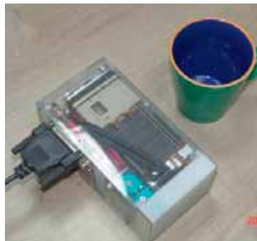
תא דלק שפותח במעבדתו של פרופ' עמנואל פלד, המופעל על-ידי מתנול ומסוגל להפעיל מחשב נישא קטן
